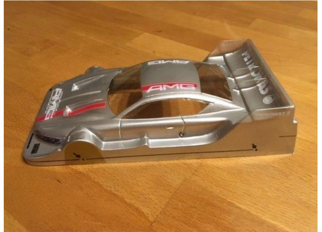
Les feux arrière doivent rester entièrement visibles. Sur les voitures où on a pas de feux visible on doit garder un bord de carrosserie de plus de 20mm mesurer du bord de l'aileron.
